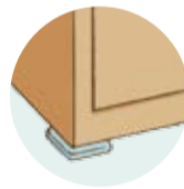
吸着マットによる固定
